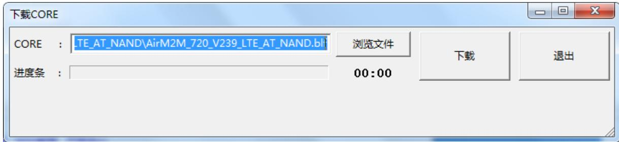
第三步：供电开关打到 ON，并长按开机键。会有下载进度条，下载完成也会有提示。
